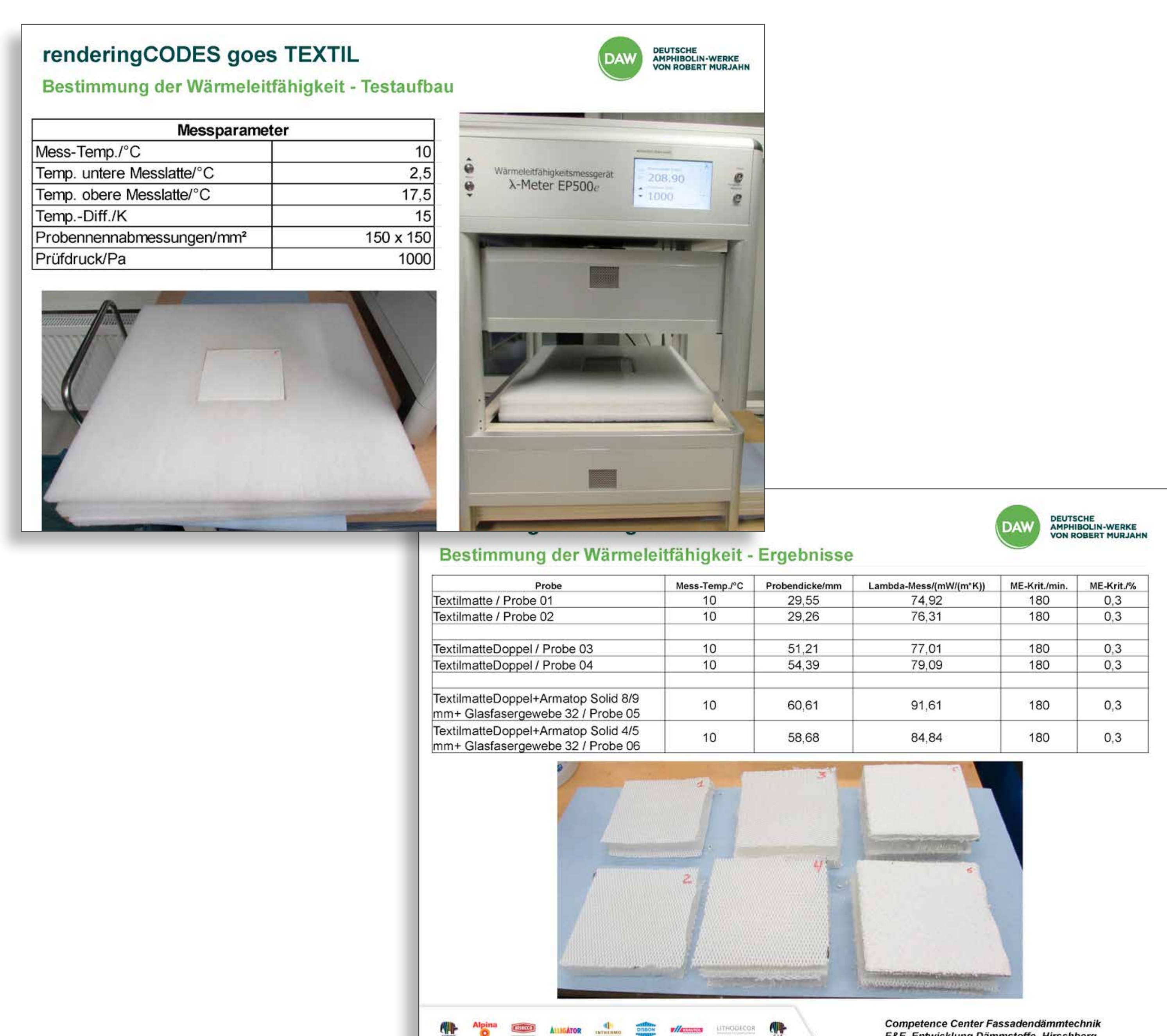
Abb. 2: Eingeschlossene Luftpolster der technischen Textilien bilden, ähnlich wie bei Funktionsbekleidung, eine einstellbare Dämmschicht, die den neuen Putz-Textil-Verbund bei vergleichbaren Messwerten leichter als herkömmlichen Dämmputz machen.
