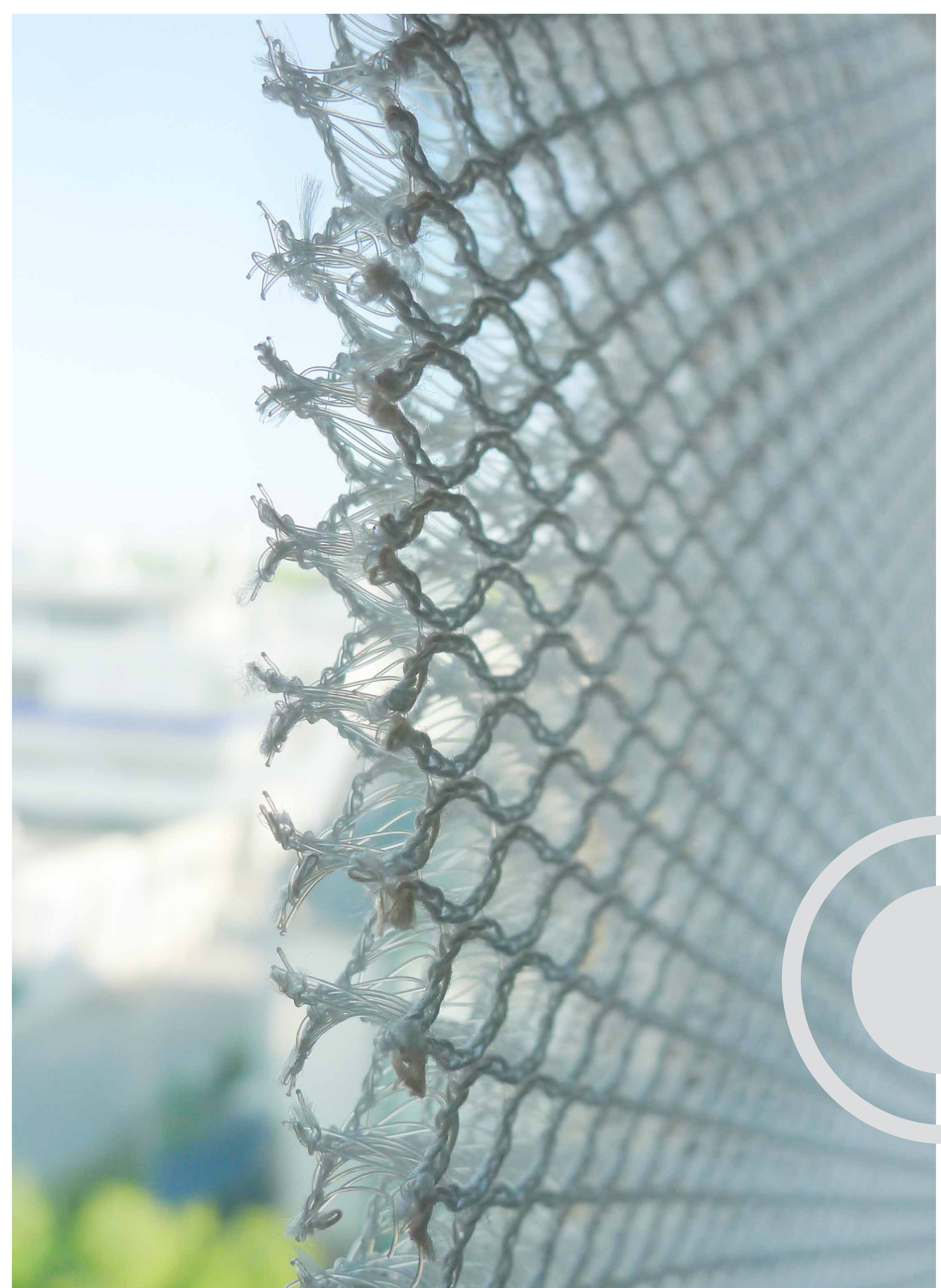
Abb. 2: Eingeschlossene Luftpolster der technischen Textilien bilden, ähnlich wie bei Funktionsbekleidung, eine einstellbare Dämmschicht, die den neuen Putz-Textil-Verbund bei vergleichbaren Messwerten leichter als herkömmlichen Dämmputz machen.
